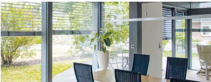
Ist der zweite Rettungsweg, zum Beispiel die Terrassentür, mit einem elektrisch betriebenen Rollläden ausgestattet, kann man einen Pufferakku einsetzen lassen, mit dem sich der Rollladen bei einem Stromausfall öffnen lässt. Foto: Laura Ludwig/dpa-mag
