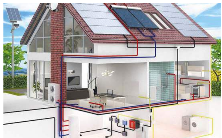
Ein Niedrigenergiehaus mit Selbstversorgung durch eine Wärmepumpe, Fotovoltaikanlage und eigenem Warmwasserkreislauf.
