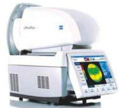
**Der i.Profiler scannt das Auge an 1 500 einzelnen Messpunkten – Basis für die besonders exakte Berechnung und Fertigung von ZEISS iScription Gläsern.**
