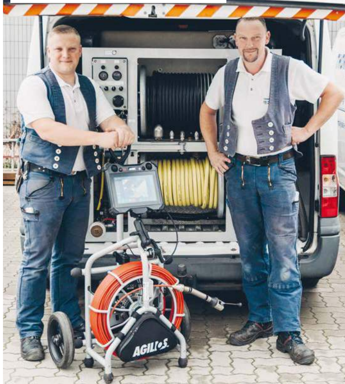
Sven Malyska (links) und Lars Malyska zeigen die in ihrem Unternehmen zum Einsatz kommende moderne Technik: ein Hochdruckspülwagen zum Reinigen und Spülen von Abwasserleitungen mit digitaler Kamera zur Dichtheitsprüfung. Foto: Malyska
